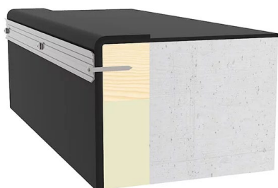
Montage auf Betonaukantung
