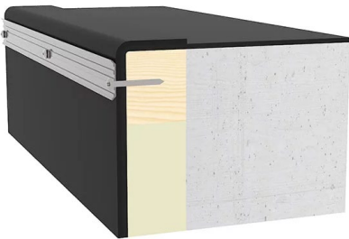
Montage auf Betonaufkantung
